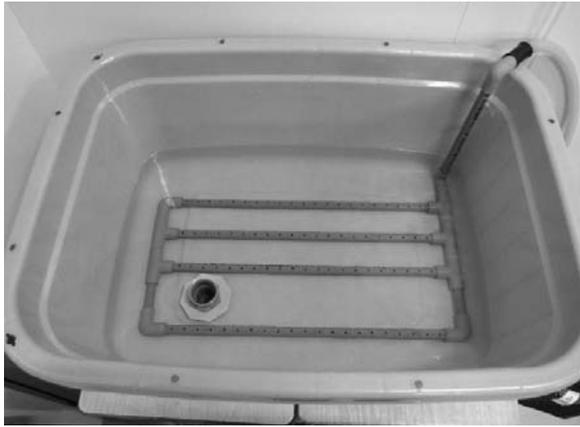
(図4-4 湧水方式での底部給水システム)
