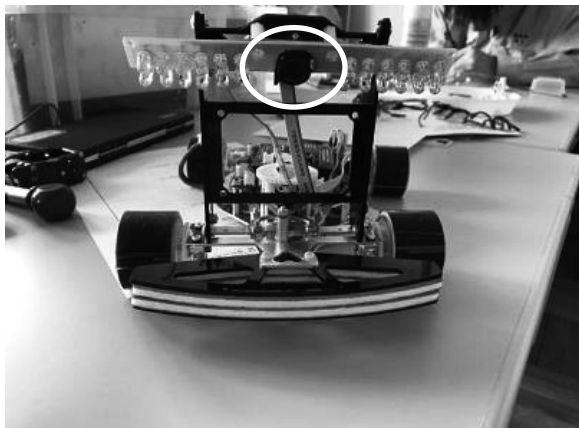
[ 図2 一次元カメラによる画像認識マイコンカー ] (図上部の○印に示すものがラインスキャンカメラ)
